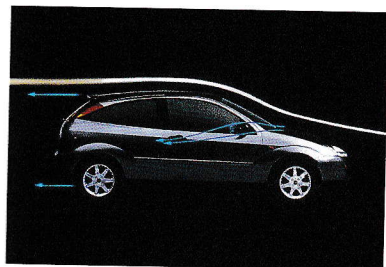
エアロダイナミクスも考慮され、空気抵抗係数0.32を達成するフォーカスのボディ。
